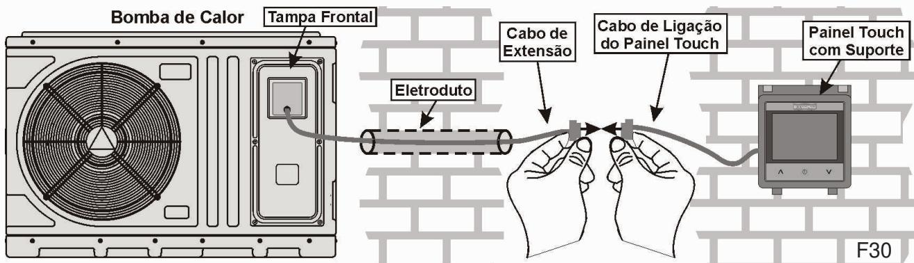
Na passagem do cabo de extensão, utilize um eletroduto com diâmetro de no mínimo 3/4". Com o suporte e o painel touch instalados, conecte os cabos de extensão e de ligação do painel. Desta forma o equipamento está pronto para o uso.
